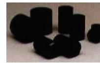
HTRの 被覆粒子 (コンパクト)
